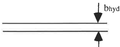
Figur 5.1 Hydrauliska vidden, b_{hyd} , för en planparallell spricka
