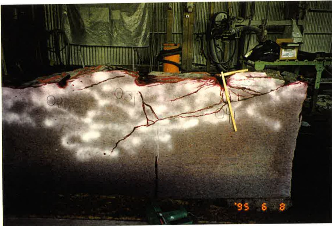
Figur 5. Sprickutbredning för Gurit 17 och initiering med Nonel LP
