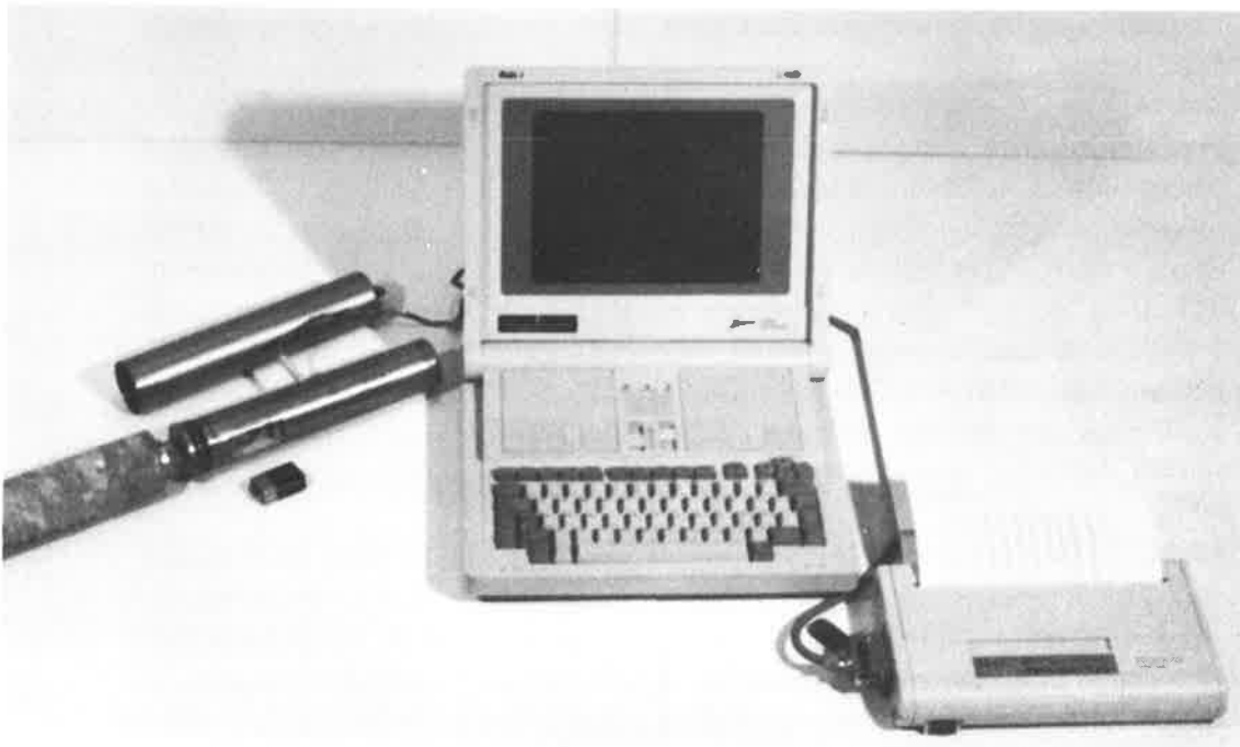
Figur 1. Bergspänningsmätutrustning: borrhålssond och dator.
