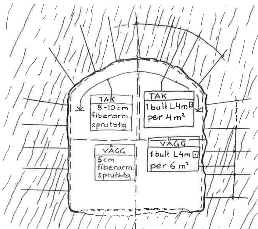
Fig 5 Normal omfattning av bergförstärkning i in- och utloppstunneln.
