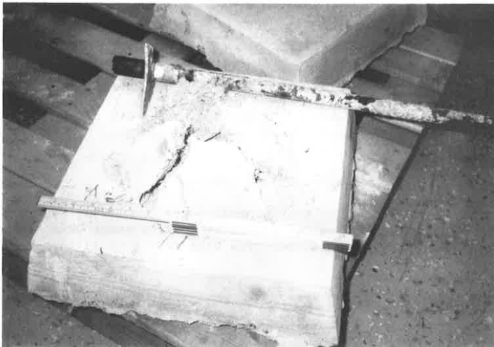
Figur 10 Ingjutna Swellex-bultar försedda med bricka provdrogs för att uppskatta upphängningsanordningens kapacitet. Pullout tests were performed to verify the load capacity of the plates on the Swellex bolts.
