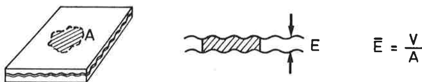
Figur 2 V = vattendroppens volym, A = arean hos den yta vattnet täcker, E = sprickvidd.
