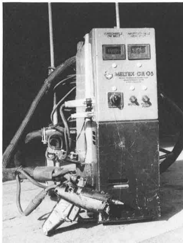
Fig 5. Smältlimanläggning av märket Meltex Set-up for uniting the slabs with Hot-Melt glue
