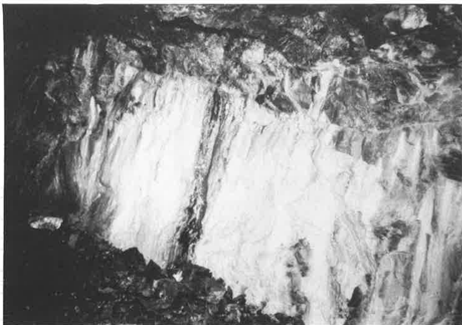
FIGUR 4 Utfällningar av järn-mangan-och kalkföre- ningar på bergyta Precipitations of compounds of iron, manga- nese and lime on rock surface
