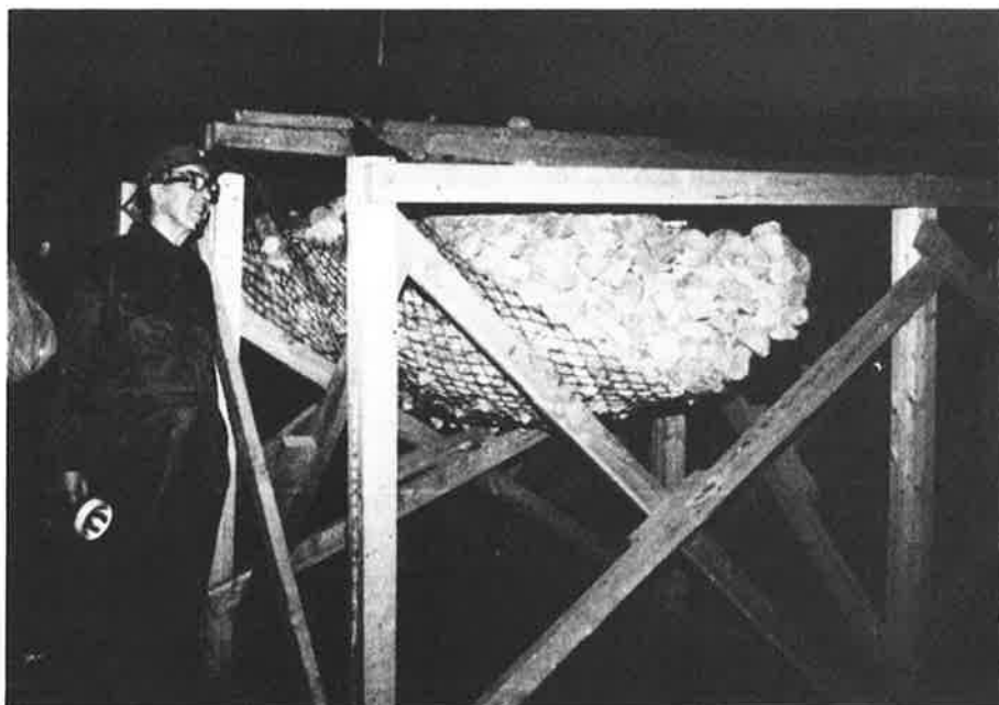
Fig. 11. Fältförsök för att prova bärformågan hos det använda bultupphängda skyddsnätet.
