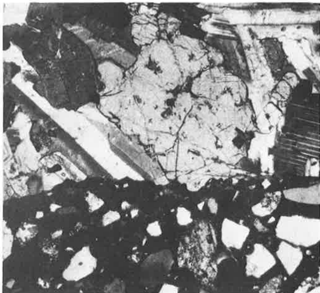
Fig 7 Slippprov av kontaktytan mellan sprubetong och rå begyta ( 30 x förstoring ) Thin section of the contact between shotcrete and fractured rock surface ( 30 x magnification )
