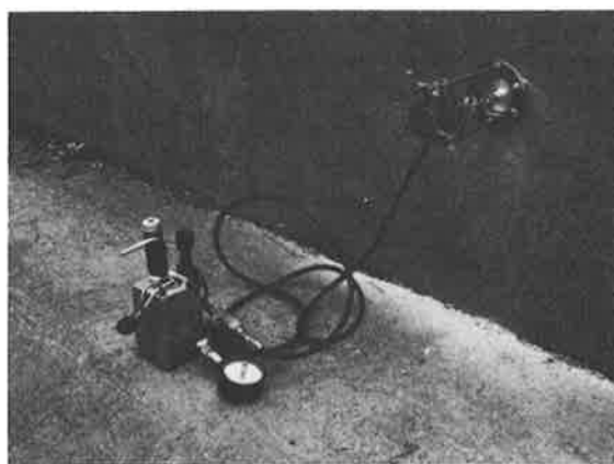
Fig. 2 Utrustning för dragprovning Equipment for pull-out test
