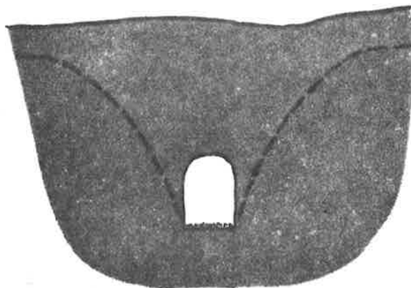
FIG. 11. Grundvattensänkning kring bergtunnel.
