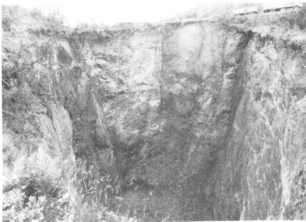
Fig. 12 Raskrateret måler ca. 50 m x 36 m. Hovedsonen ligger mot sleppeflaten til venstre. Midt på bildet går en amfibolittgang.
