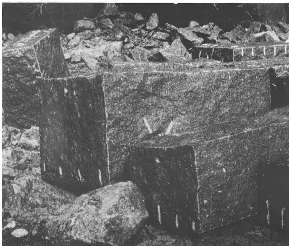
Figur 2.6 De horisontella svaghetsplanen, som ofta är utbildade som sprickor, s k bottnar, har stor betydelse när det gäller att genom kilning få loss längsträckta parallelepipediska stycken från berget.
