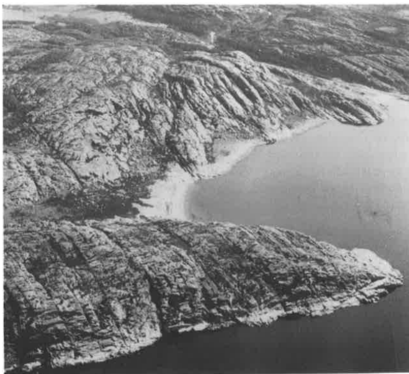
Figur 2.19 Granitberg i Bohuslän av havet befriat från lösa jordarter. Ytberget är starkt uppsprucket men på 50-100 meters djup är bergmassan mycket hel.
