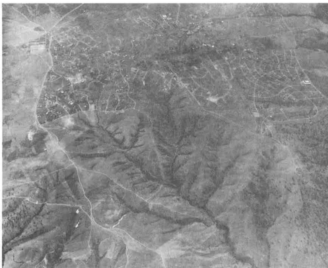
Figur 3.8 Exempel på flygbildens användbarhet vid identifiering av dräneringsvägar. Spanien.
